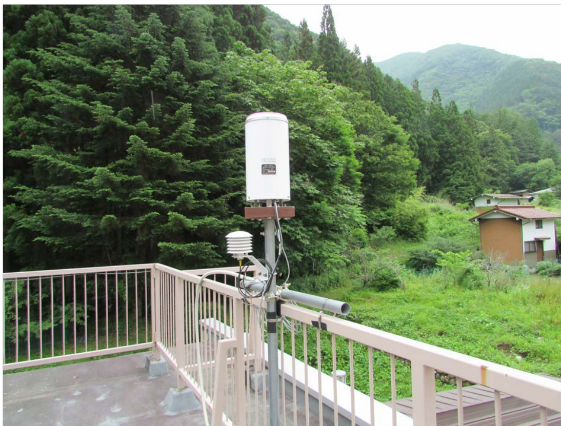
図-2.1 栃尾小学校校舎屋上に設置した転倒ます式雨量計と温湿度計
